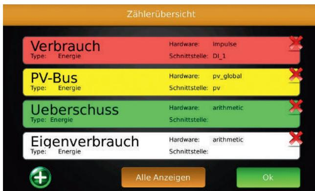
Legen Sie hier fest, ob Sie einen BUS-Zähler (2 Richtungen) einen Wärmemengen-zähler, einen der Digitaleingänge als Zähler verwenden möchten, oder ob Sie einen arithmetischen Zähler oder einen „Smart Meter“ Zähler anlegen wollen. Wechselrichter, deren Protokoll noch nicht integriert ist, können ebenfalls über einen z.B.: Drehstromzähler angeschlossen werden. Hier kann die Funktions-Zähler als Wechselrichter verwendet werden.
