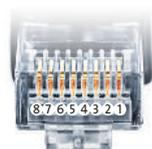
Belegung RJ45 Ethernet-Patchkabel
