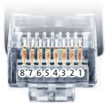
Belegung RJ45 Ethernet-Patchkabel
