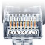
Belegung RJ45 Ethernet-Patchkabel
