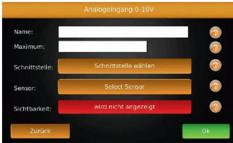
Sensoren mit 0-10V Ausgang können an den Analogeingang 1 + 2 angeschlossen werden.
