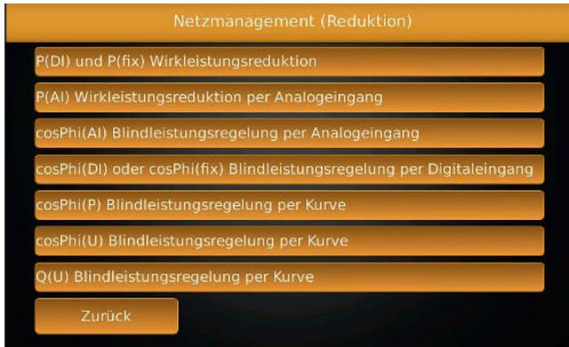
Seit 2009 gibt es in Deutschland die Regelung, dass Photovoltaikanlagen an einem Einspeisemanagement (gesteuert über einen Rundsteuerempfänger des Energieversorgers) teilnehmen müssen. Die Anlagen müssen demnach über eine Möglichkeit verfügen, Ihre eingespeiste Wirkleistung reduzieren zu können, um das Netz nicht zu überlasten.
