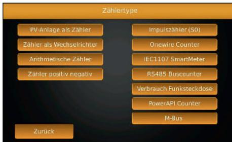
Dieser Zähler kann durch Bildung einer Differenz zwischen den beiden Zählern „Produktion“ und „Verbrauch“ einen Zähler „Netzbezug“ bilden (wenn Verbrauch > Produktion = Netzbezug). Dieser Zähler kann z.B. die vom Netz bezogene Energie bei Eigenverbrauchsanlagen erfassen und aufzeichnen. Dieser Zähler wird nicht negativ (wenn Produktion > Verbrauch, dann ist Netzbezug = 0).
