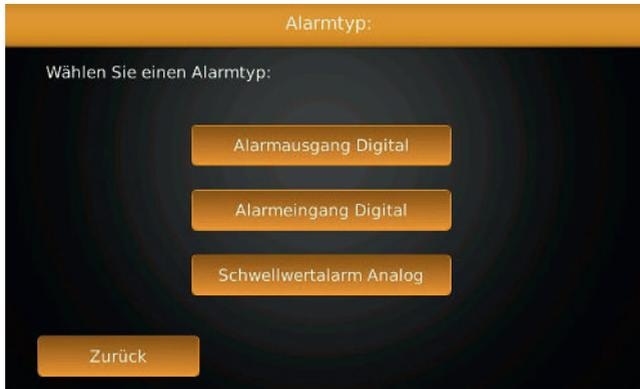
Mit dem PowerDog®-System haben Sie die Möglichkeit, bis zu 4 Digitaleingänge als Alarমেingänge zu benutzen oder bei Über-/Unterschreitung eines Schwellwertes (Temperatur, Zahlenwert, etc.) einen Alarm auszulösen.
