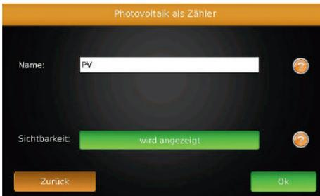
Es werden automatisch die über Bus eingelesenen Photovoltaikenergiewerte als Zähler eingefügt, um mit diesem Zählerwert weitere Zähler zu generieren (Eigenverbrauch, Netzspeisung, Netzbezug etc.).
