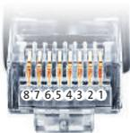
Belegung RJ45 Ethernet-Patchkabel
