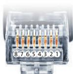
Belegung RJ45 Ethernet-Patchkabel
