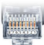
Belegung RJ45 Ethernet-Patchkabel
