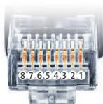
Belegung RJ45 Ethernet-Patchkabel
