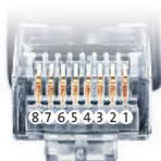
Belegung RJ45 Ethernet-Patchkabel
