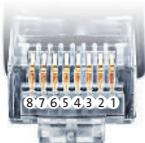
Belegung RJ45 Ethernet-Patchkabel
