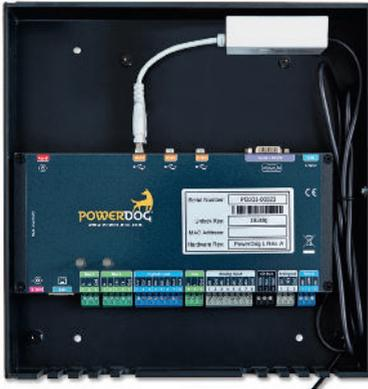
Legen Sie das Analogmodem in den oberen freien Bereich des PowerDog® und stecken das USB-Kabel in eine der drei USB-Buchsen (siehe Bild oben) und verlegen Sie das mitgelieferte 4-polige Telefonkabel bis zur Telefondose. Stecken Sie den RJ11-Stecker in das Analogmodem und den Telefonstecker in eine Telefondose in einen der Steckplätze mit der Bezeichnung „N“ oder „Δ“ oder „O“. Falls Sie einen ISDN-Anschluss haben, verwenden Sie einen Analoganschluss der Telefonanlage.
