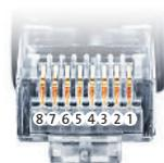
Belegung RJ45 Ethernet-Patchkabel
