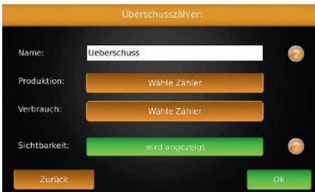
Dieser Zähler kann durch bilden einer Differenz zwischen den beiden Zählern Produktion und Verbrauch einen Zähler Überschuss bilden.
