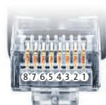
Belegung RJ45 Ethernet-Patchkabel
