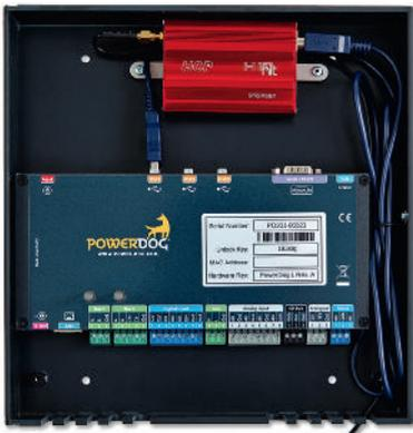
Montieren Sie das GSM-Modem mit den mitgelieferten Montagelaschen entweder wie im Bild oben im PowerDog® an die dafür vorgesehenen Gewindedome oberhalb der Platine, oder mit zwei Dübeln und Schrauben an eine Wand. Stecken Sie das beiliegende USB-Kabel in das GSM-Modem und in einen der drei USB-Anschlüsse am PowerDog®. Verwenden Sie ausschließlich das mitge-
