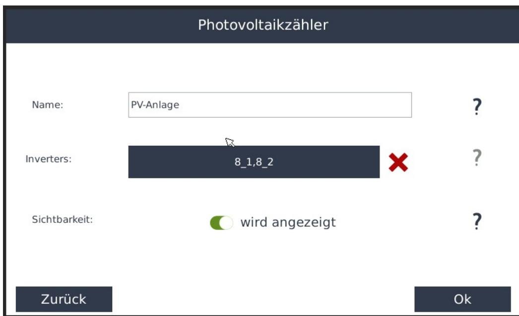
Hier wird nun ein beliebiger Name gewählt (in unserem Fall PV), anschließend können beliebige Wechselrichter ausgewählt werden. Wenn Sie nichts auswählen werden automatisch alle Wechselrichter gewählt.
