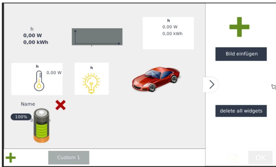
Sie können sämtliche Parameter die in der Steuerung zur Verfügung stehen wie Wechselrichter, Modulfelder, Zähler, Sensoren, Ladestationen und sogar die Schalthandlungen der Regler (Relais, Digitalausgang, Analogausgang oder -eingang ) anzeigen, um so z.B. die Funktion der Regelung zu überprüfen.
