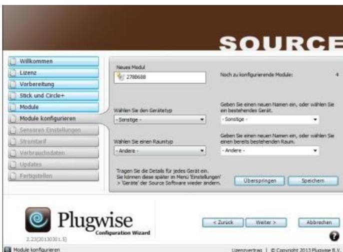
Bei „Module konfigurieren“ muss jeder Circle konfiguriert werden. Wählen Sie bei „Gerätetyp“ „Sonstige“. Wählen Sie bei „Raumtype“ „Andere“. Gehen Sie auf „Speichern“. Wiederholen Sie diesen Vorgang so oft, bis im „Configurations Wizard“ bei „noch zu konfigurierende Module“ „0“ steht. Gehen Sie danach auf „Weiter“.
