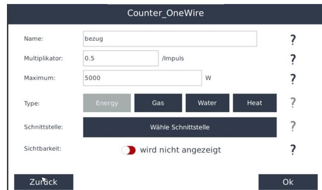
Wählen Sie nun die Schnitt-stelle, an der Sie den Impuls-ausgang des Drehstromzählers angeschlossen haben.
