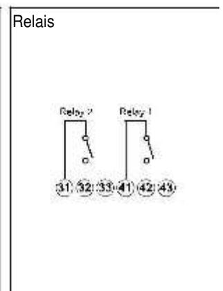
Die Widerstandslast (Rc) muss so bemessen werden, dass der geschlossene Kontaktstrom unter 100mA liegt, die Versorgungsspannung "VDC" muss niedriger oder gleich groß wie 30VDC sein.
